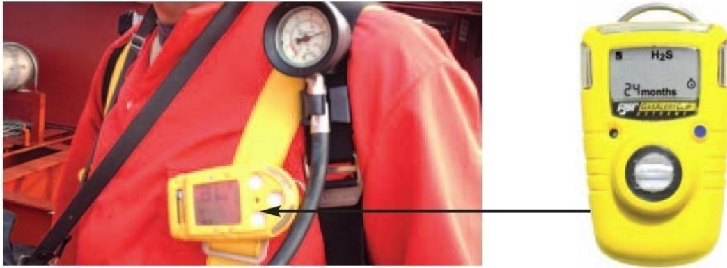
Gbr. 1. Contoh peralatan pengukur oksigen dan H2S
