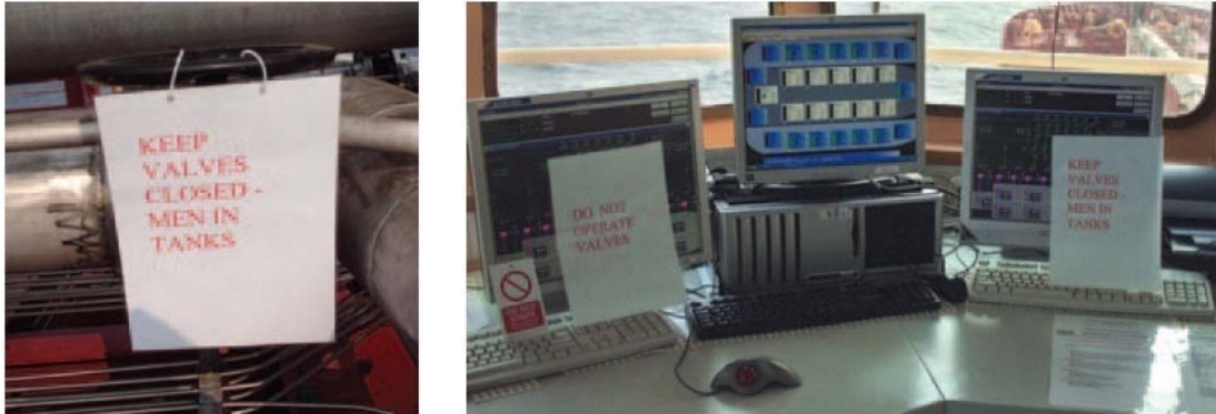
Gbr. 2. Contoh Tanda Peringatan di Peralatan Pengendali
