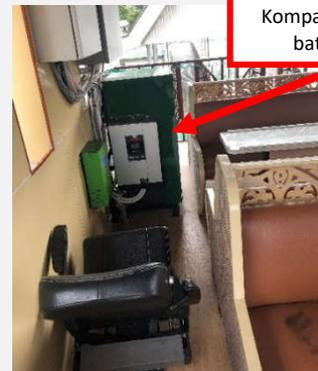
Instalasi baterai di ruang penumpang, baterai yang dipasang oleh generator panel surya yang terpasang di atas kompas deck kapal
